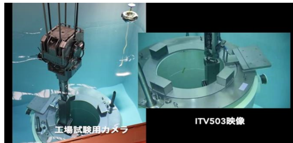
水中動作試験状況（燃料模擬体）
