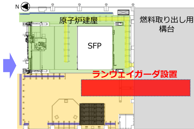
ステップ②ランウェイガード設置 完了
