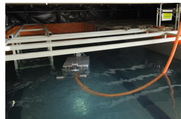
↑ 容器封入作業用ROVの遊泳試験の状況
