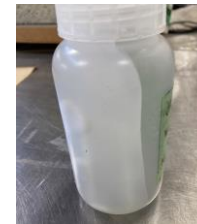
図1 CaCl 2 含有によりアルカリ活性剤が硬化した様子
