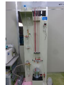
図4 変水位透水試験装置 (JIS規格準拠)
