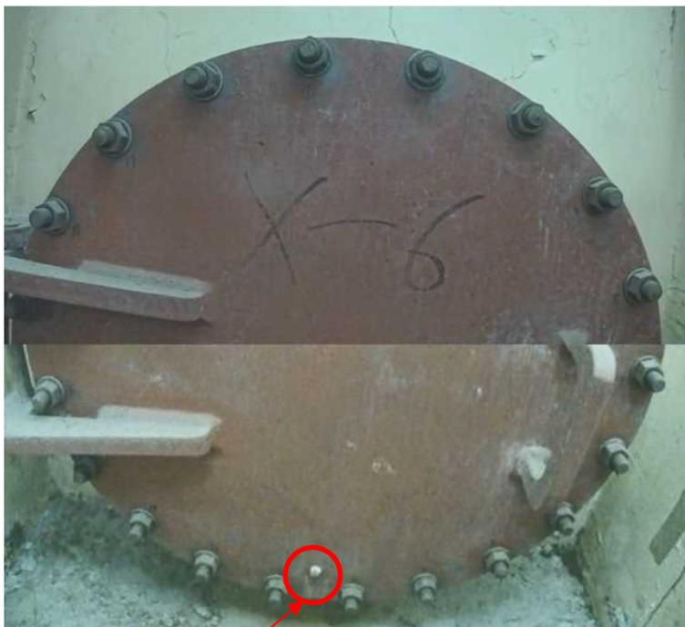
フランジ漏洩試験のためのN<sub>2</sub>封入ライン
