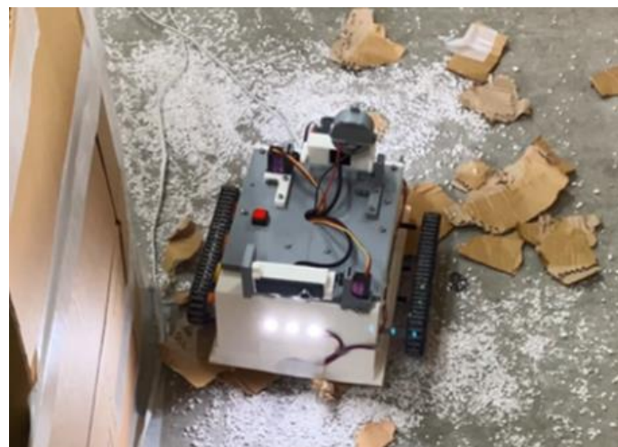
画像 4 : 床面の砂および塗装膜破片を模擬した走行試験の状況
