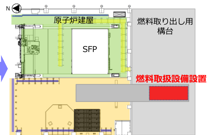
ステップ③燃料取扱設備設置
