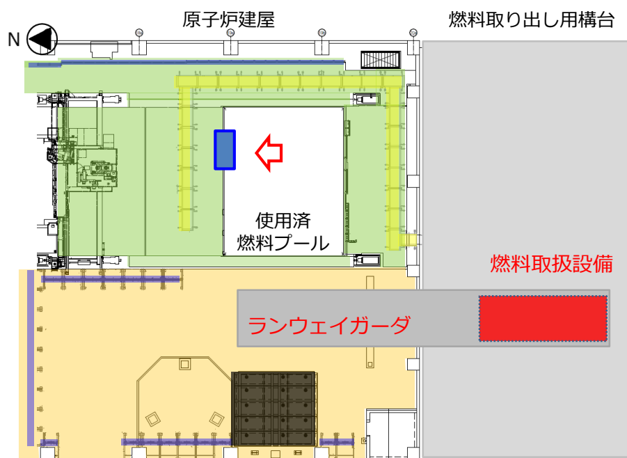
浄化装置設置予定箇所
