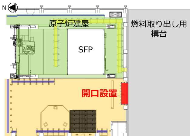
ステップ①開口設置
