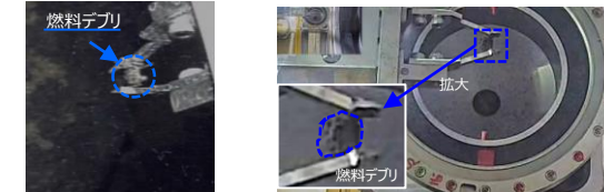
燃料デブリを先端治具で把持した状況 把持した燃料デブリを運搬用ボックスに回収する様子
