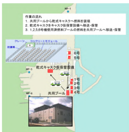
図 39 共用プール・乾式キャスク仮保管設備配置図、及び作業の流れ
