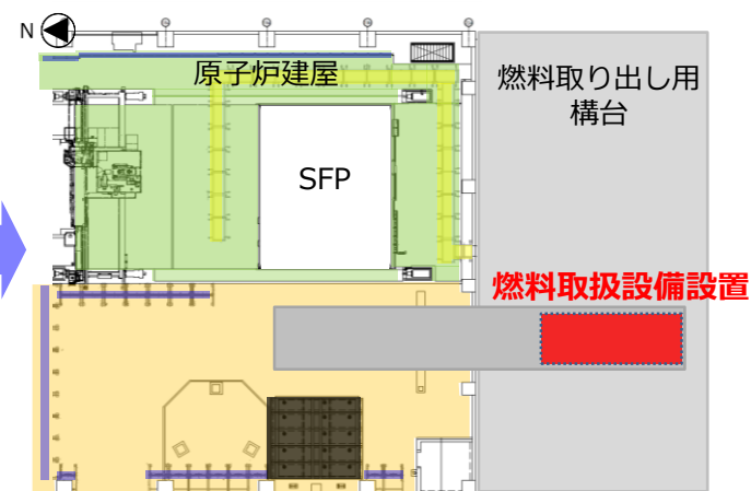
ステップ③燃料取扱設備設置
