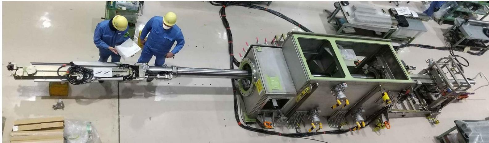
テレスコ式試験的取り出し装置（装置を上方から撮影）
