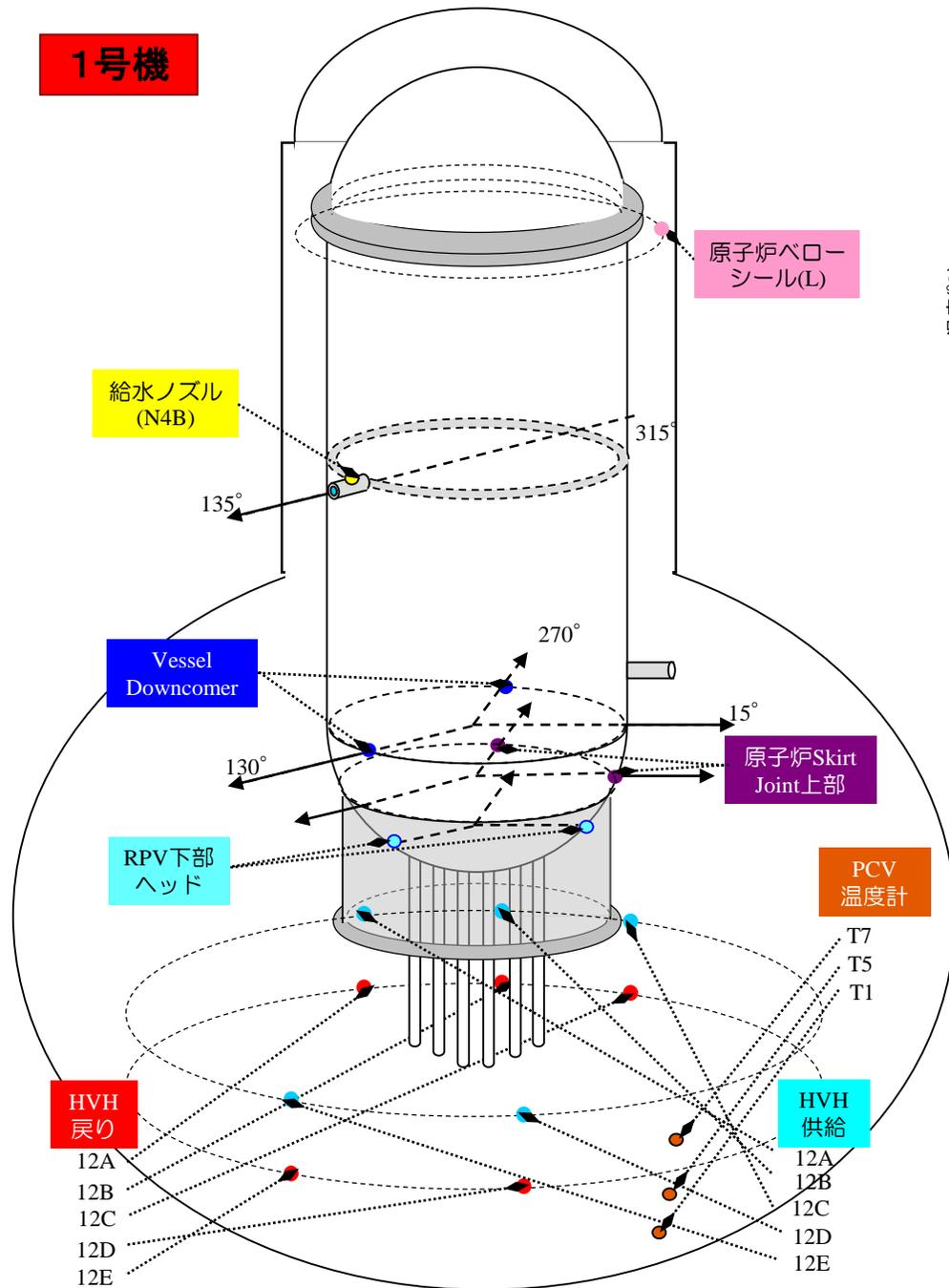
1号機 原子炉圧力容器まわり温度(1/1~7/23)
