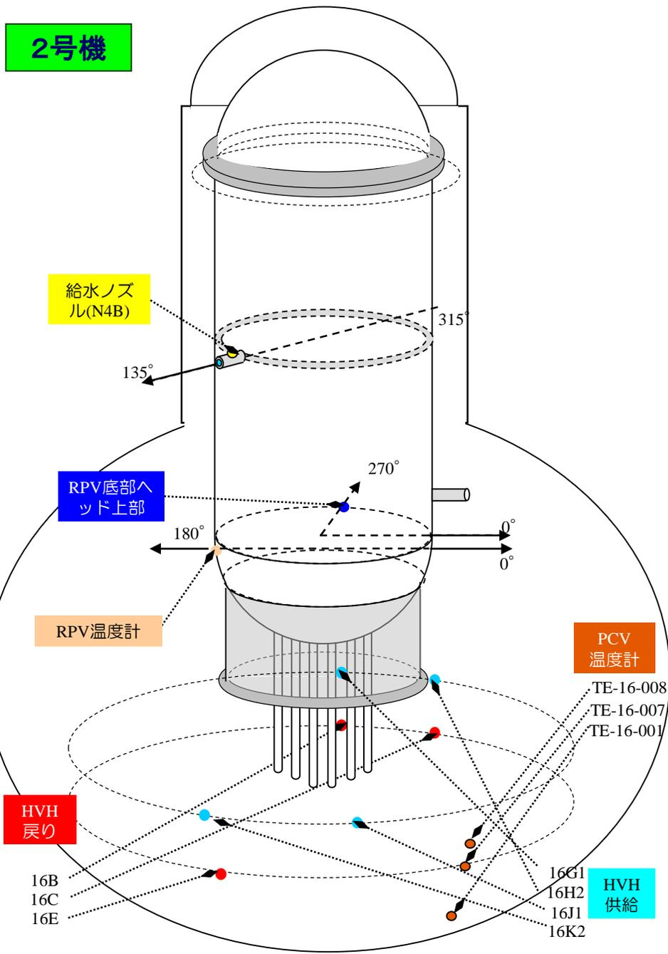
2号機 原子炉圧力容器まわり温度(1/1~7/23)
