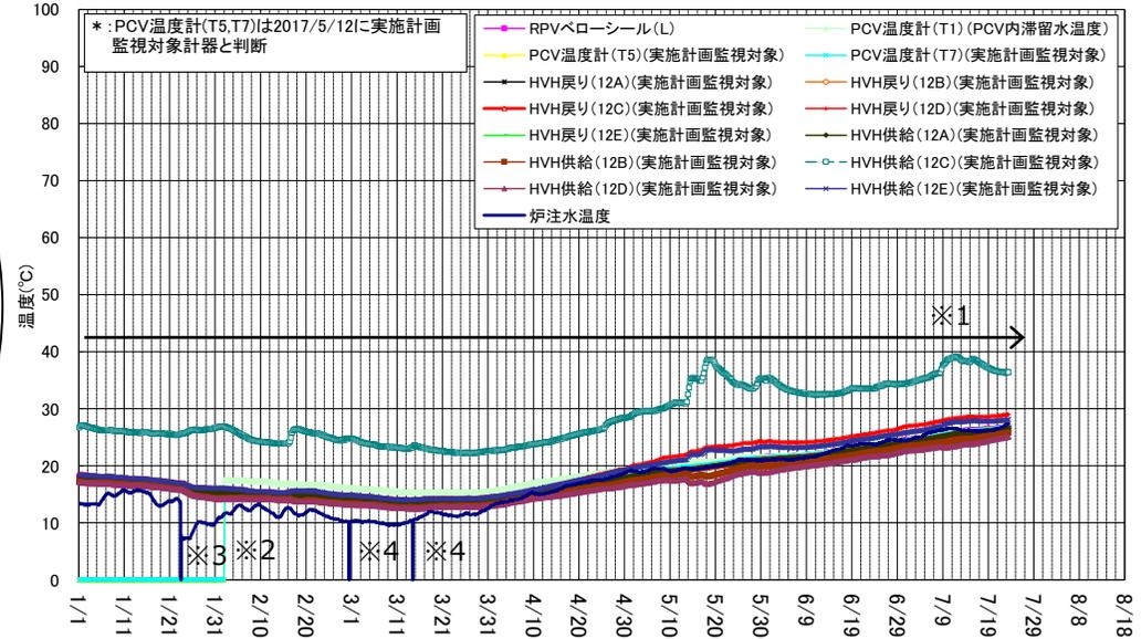
※1 2021/6/11~ 大気圧の変動に伴い一部の温度計のデータが変動
