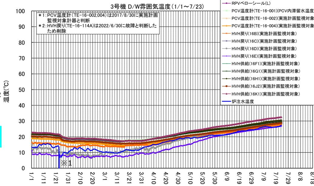
※1 2024/1/23 炉注水源切替(2号機CST→3号機CST)に伴い、グラフの炉注水温度データが欠測
