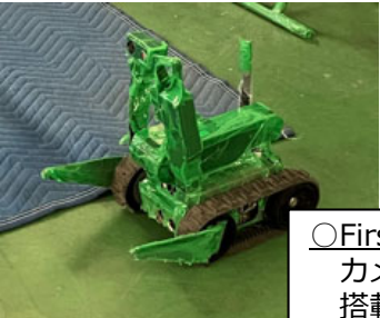
○SPOT カメラ/線量計/点群データ 取得装置を搭載し、2,3階を 移動・調査
