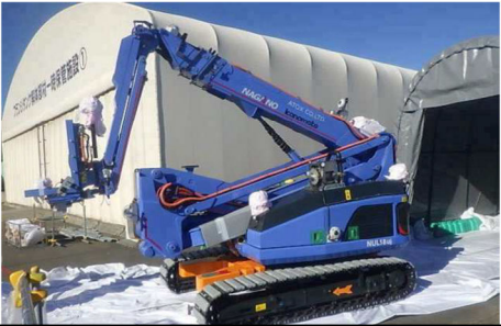
○高所作業台車 γイメージャ/FirstLook/SPOTを 搭載するための架台を設置し、 各階に運搬
