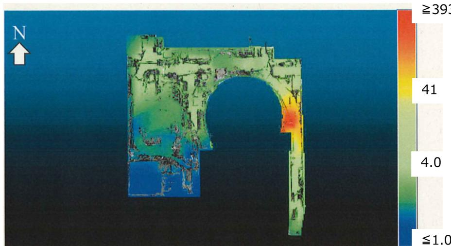
1号機R/B 3階 床上近傍0.20mの線量率分布 [mSv/h]
