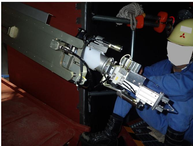
ペDESTアル内への先端治具の挿入
