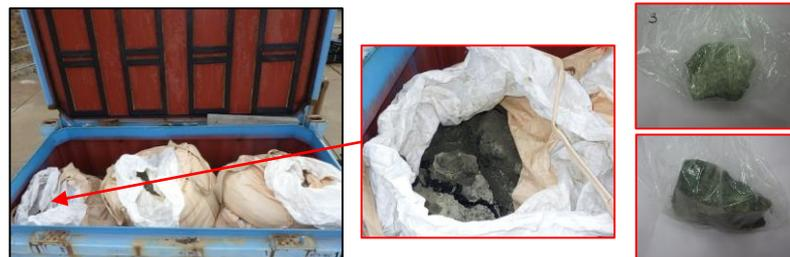
コンテナ詰替え作業時に採取した瓦礫コンクリート試料
