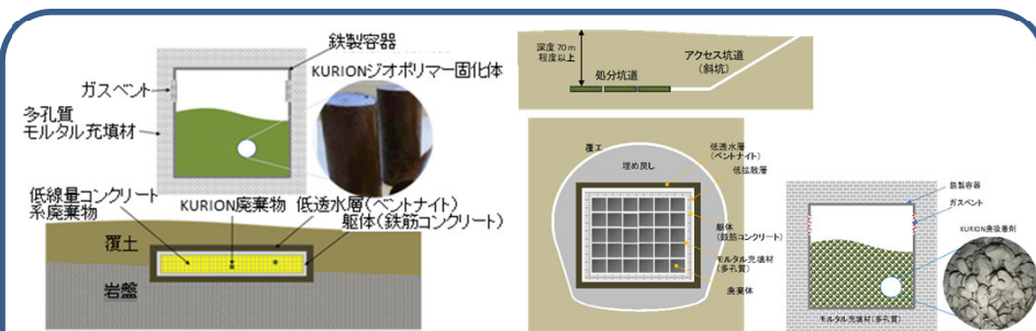
図1 KURIONの浅地中ピット処分(左)および中深度処分(右)の概念例
