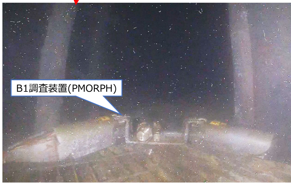
写真2. 南側B1調査装置(PMORPH)の残置状況
