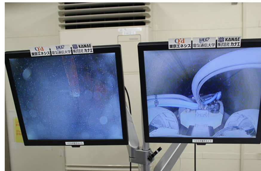
写真2.ヘビ型ロボットインストール状況 (左画面：前方カメラ 右画面：後方カメラ)
