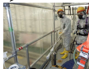
収納容器表面線量率, 汚染測定
