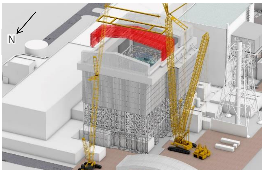
可動屋根設置中
