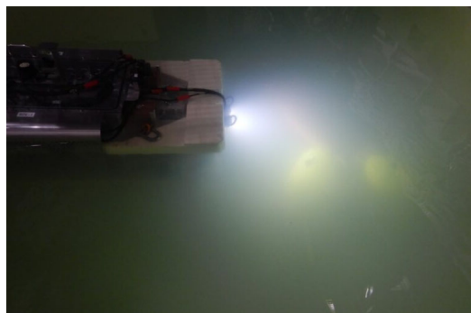
ゼオライト回収作業後（濁度上昇）
