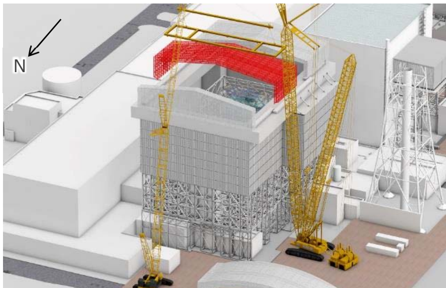
可動屋根設置中
