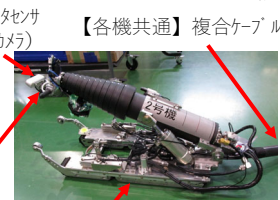
図2 調査装置の外観 (2機目:点群データセンサ搭載)
