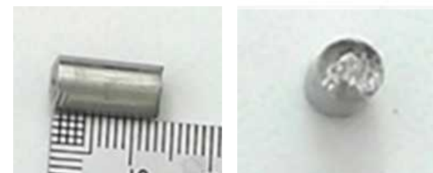
ピン破損状況
