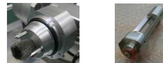
燃料デブリ回収装置先端部
