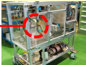
レーザー照射部（微粒子吸引ノズル付き）
