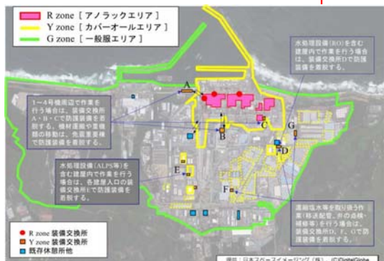
2016年3月、放射線防護装備の適正化福島第一原子力発電所敷地内の環境線量低減対策の進捗を踏まえて、1～4号機建屋周辺等の汚染の高いエリアとそれ以外のエリアを区分し、各区分に応じた防護装備の適正化の運用を限定的に開始。
