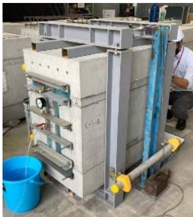
写真1 加圧試験状況
