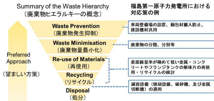
図 15 NDA における廃棄物ヒエラルキーの概念と福島第一原子力発電所における対応策
