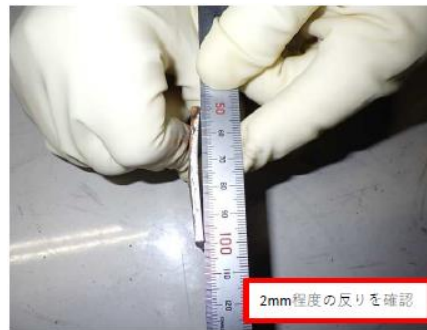
ボルト及び座金等 締結部材の状態
