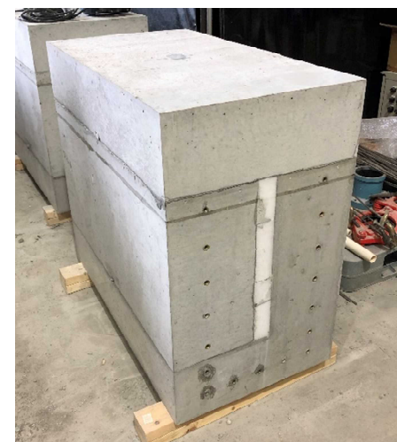
手順 6 : 上部設置 (試験体完成)
