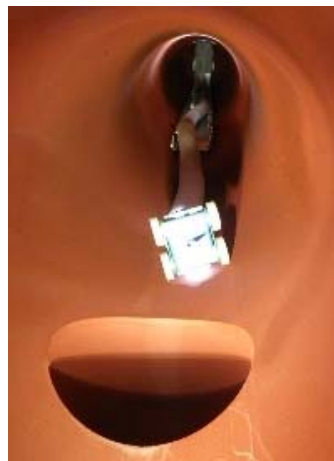
配管内アクセス装置
