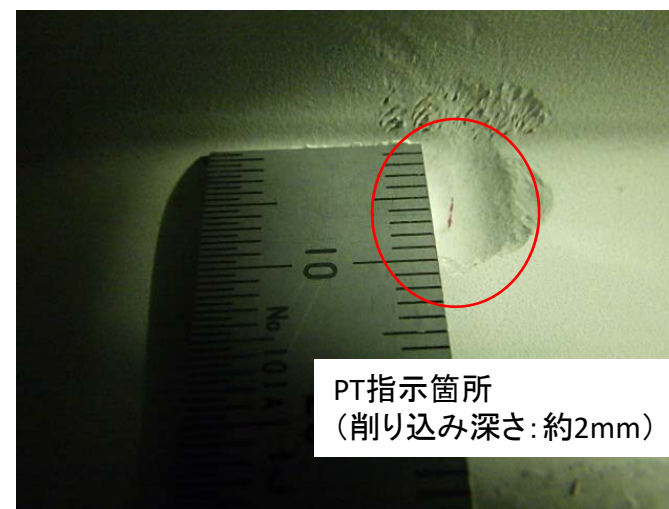
PT指示箇所の代表例 (削り込み後)
