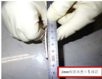
ボルト及び座金等 締結部材の状態
