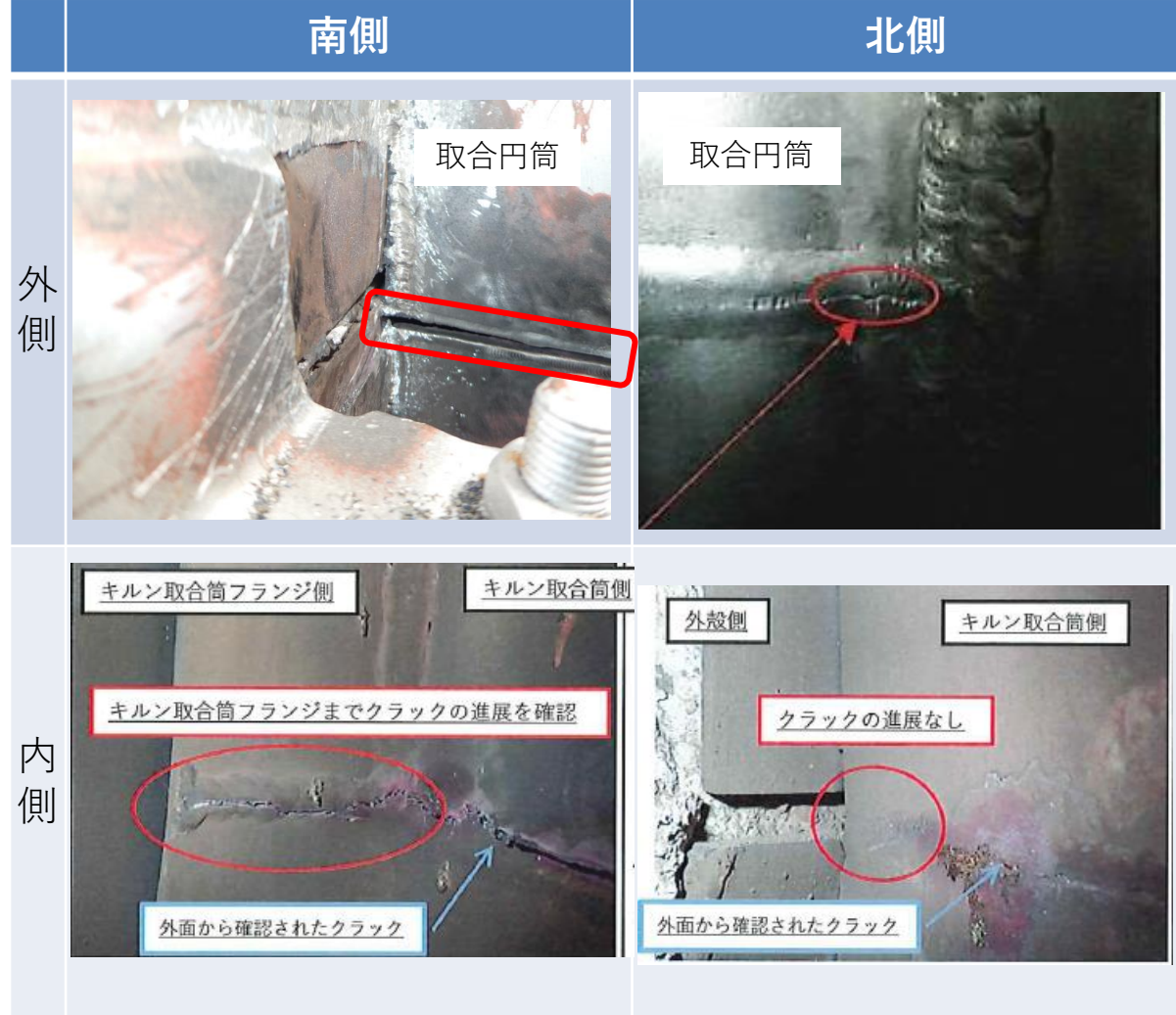
亀裂発生箇所の構造 (上: 南側、下: 北側)
