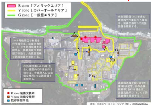
2016年3月、放射線防護装備の適正化福島第一原子力発電所敷地内の環境線量低減対策の進捗を踏まえて、1～4号機建屋周辺等の汚染の高いエリアとそれ以外のエリアを区分し、各区分に応じた防護装備の適正化の運用を限定的に開始。
