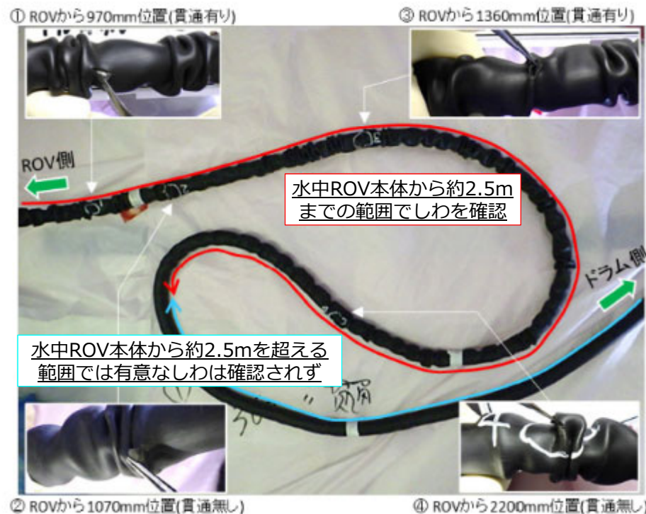
写真1.ケーブル被覆のしわの状況
