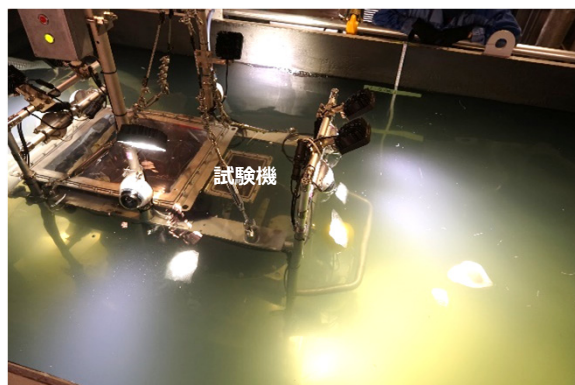
試験機の水槽での要素試験
