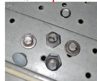
接合部のボルトが破断
