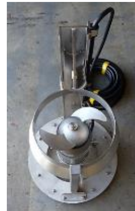
測定・確認用タンクに設置する攪拌装置
