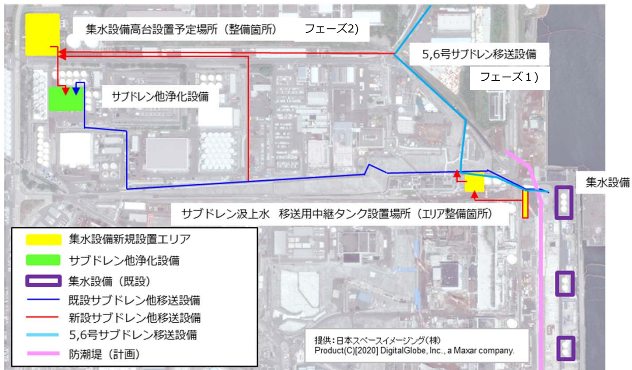
※サブドレン移送配管計画図 (案)
