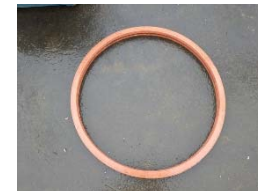
当該漏えい箇所のゴムリング
