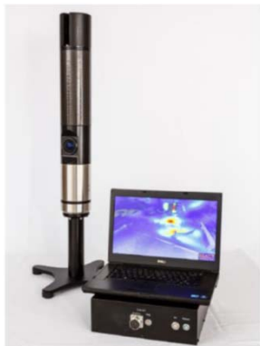
○γイメージャ γ線源強度の測定結果と3Dスキャン情報を組み合わせ、γ線源強度の3次元分布を取得
