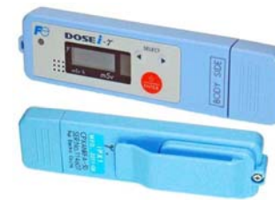
○線量計 （左）Dosei-γ：γイメージャ設置箇所の空間線量率を測定
