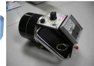
○線量計 （左）Dosei-γ：γイメージャ設置箇所の空間線量率を測定
