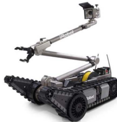
○PackBot（遠隔操作ロボット） 各種測定機器を搭載し、運搬・設置を行う
