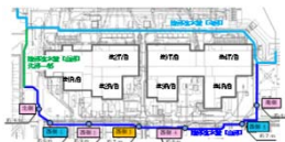
陸側遮水壁（山側）の閉合箇所
