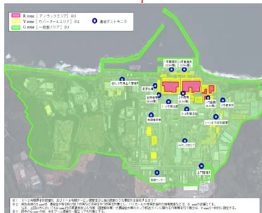
2018年5月、構内の約96%のエリアで一般作業服と使い捨て防じんマスクなどの軽装備で作業可能。
