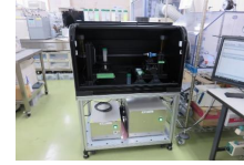
図3 試作した画像判定装置（左）と測定例（右：セメント混練水と模擬廃棄物の反応熱）
