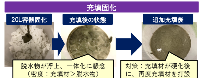
図2 セメントによるALPSスラリー脱水物(塊状模擬物)の充填固化試験の様子
