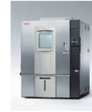
図5 曝露試験に用いている調温調湿装置と型枠に打設した固化体
