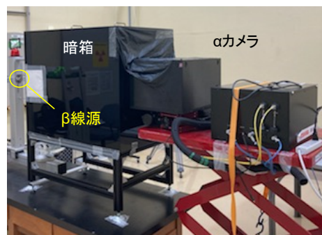
図2 アルファカメラのβ線源による発光試験
