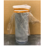
図5 曝露試験に用いている調温調湿装置と型枠に打設した固化体
