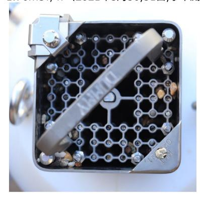
試験後燃料集合体上部 (ダミー燃料)
