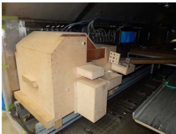
模擬アーム組み込み（根元部）
