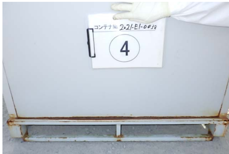
写真3.側面下部に著しい腐食があるコンテナ (E1エリア, 5月13日撮影)
