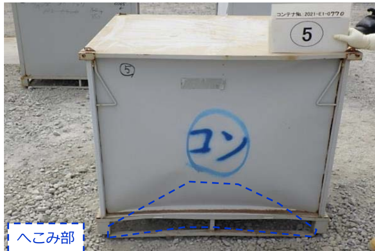
写真9.側面下部に著しいへこみがあるコンテナ (E1エリア, 7月20日撮影)
