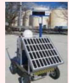
線量率モニタの設置状況
