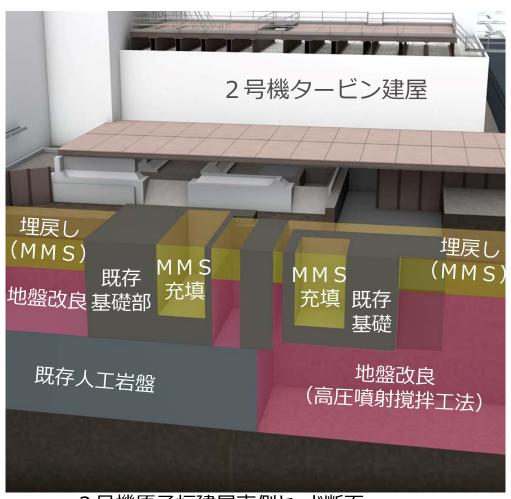
2号機原子炉建屋南側ヤード断面
