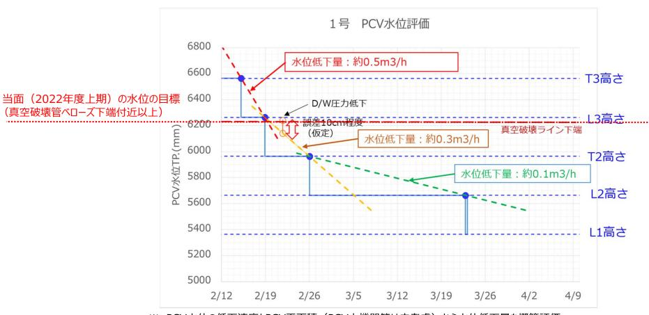
※ PCV水位の低下速度とPCV平面積(PCV内機器等は未考慮)から水位低下量を概算評価なお、PCV水位は水位計または温度計の各区間毎に直線的に低下したものとして評価
