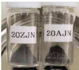
図1 作製した模擬燃料デブリ
