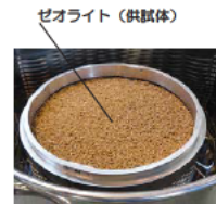
図4 乾燥試験用供試体
