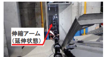
図3 検証試験の状況 (CRD開口部への進入状況)
