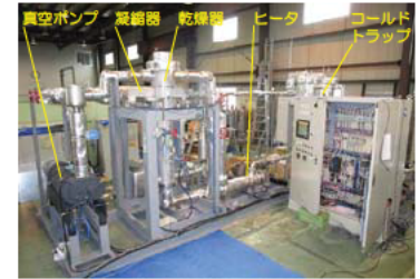
図5 乾燥試験装置
