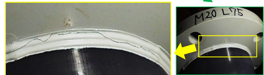
フランジ付け根部の割れ
