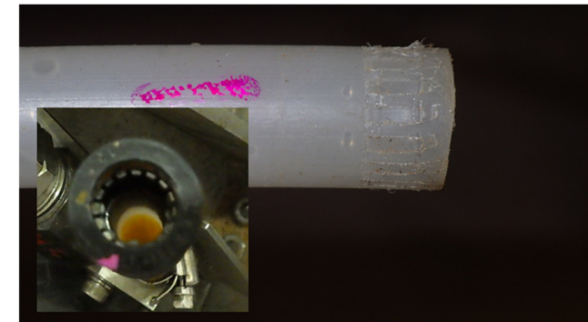
ジョイント部から引っ張られた痕
