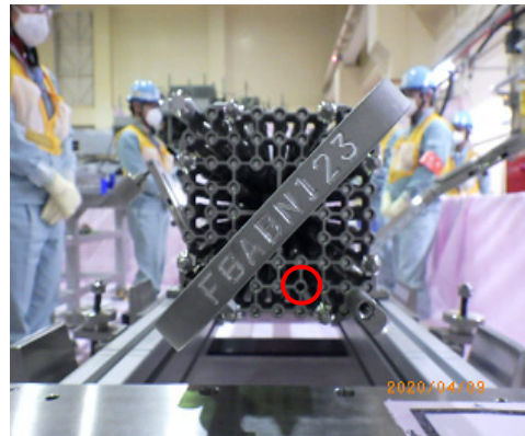
上部タイプレートの取り付け
